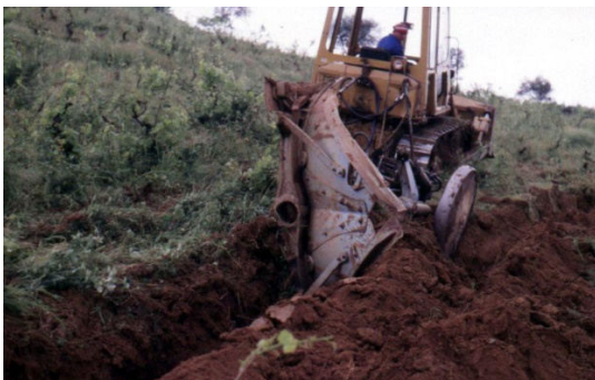
Figura 4.2 - Preparação do solo com inversão de leiva usando uma charrua de surribo
