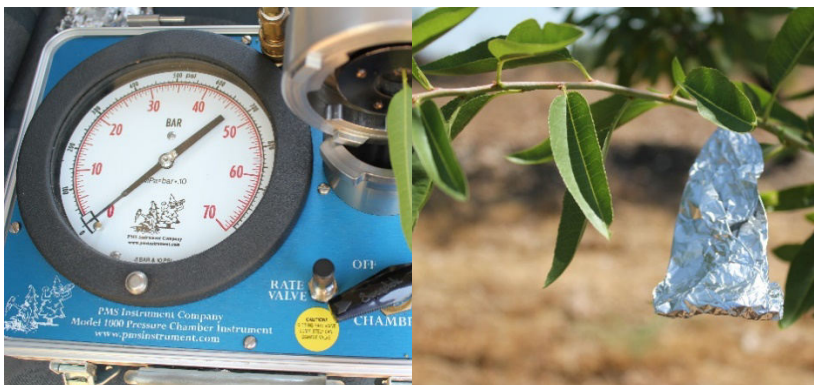
Figura 9.5 - Câmara de pressão (esquerda) e folha coberta para posterior medição do potencial hídrico do ramo (direita)
