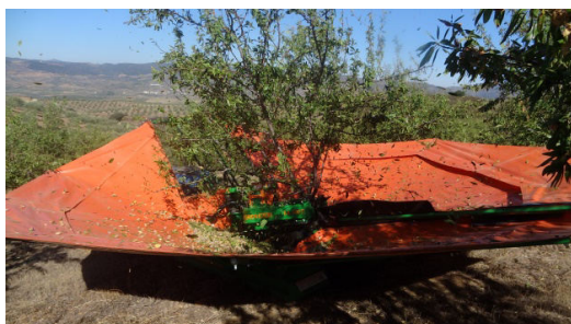
Figura 12.11 - Vibrador de troncos com avara frutos aberto durante o destaque (Foto R. Tranchete)
