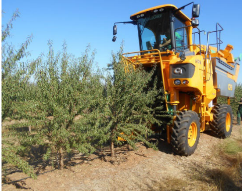
Figura 12.14 - Vibrador de copa em trabalho de colheita em amendoal em sebe (Herdade da Torre das Figueiras, Monforte) (Foto A. Dias)
