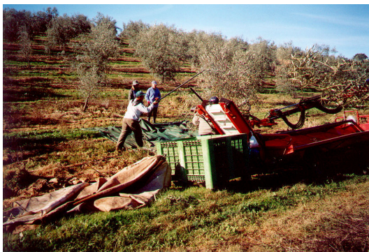
Figura 12.8 - Enrolador de panos com recolha para caixas
