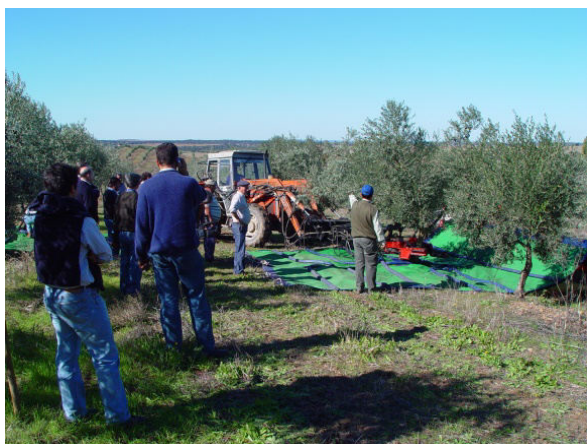
Figura 12.7 - Destaque dos frutos com vibrador e recolha com enrolador de panos
